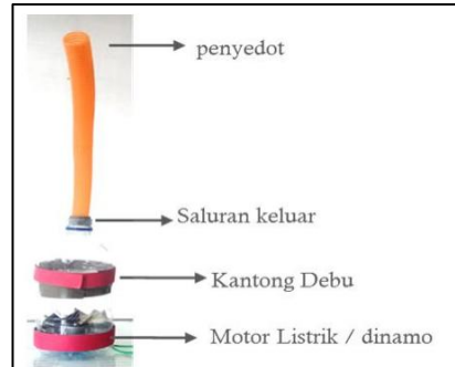
Gambar 2. Desain Produk Vacuum Cleaner sederhana. (Nurlaili dkk., 2018)
