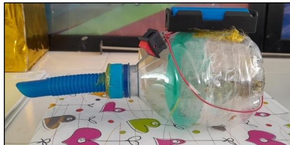
Gambar 3. Produk Vacuum Cleaner Sederhana
