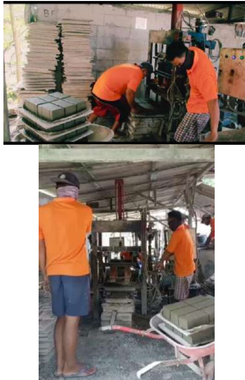
Gambar 5: Pembuatan paving dengan mesin paving block
